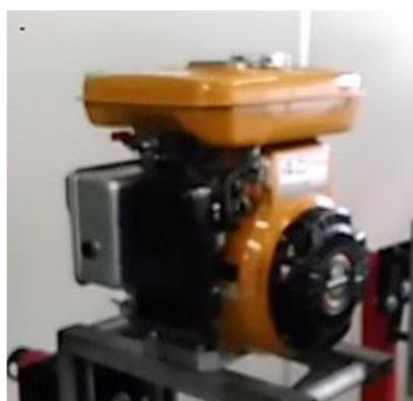
発電機やポンプ、農業機械用に主に使われる。小型で構造が比較的簡単であり、学生の初期段階の実習用エンジンとして適している。自動車用エンジンの近年主流である DOHC(Double Over Head Camshaft)エンジンではなく、より構造が簡単で基本的なエンジンである、SOHC(Single Over Head Camshaft)や OHV(Over Head Valve)、SV(Side Valve)である。
